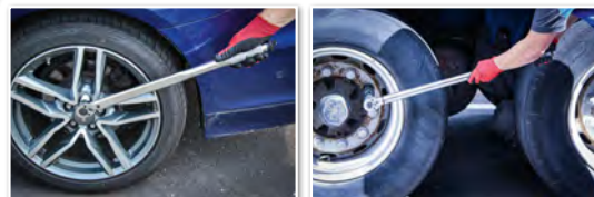
Drehmomentschlüssel | Abtrieb Außenvierkant 12,5 mm (1/2") | 70 - 350 Nm
